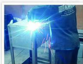
Serviço de Caldeira c/ Soldas MIG
