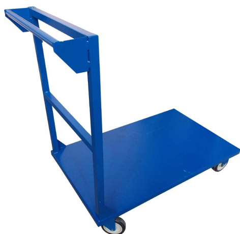
TC 404 CARRINHO PLATAFORMA - TAMPO AÇO - PUXADOR EM TUBO - RODIZIOS DE 6" - SENDO 2 FIXOS, 1 GIRATÓRIOS, - 1 GIRATÓRIO COM FREIO - CAPACIDADE CARGA 300KGS
