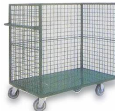
TC 407 CARRINHO PLATAFORMA TELADO - FRENTE ABERTA - PUXADOR LATERAL - TAMPO EM AÇO - RODIZIOS DE 6" - SENDO 2 FIXOS, 1 GIRATÓRIOS, - 1 GIRATÓRIO C/ FREIO - CAPACIDADE CARGA 300KGS
